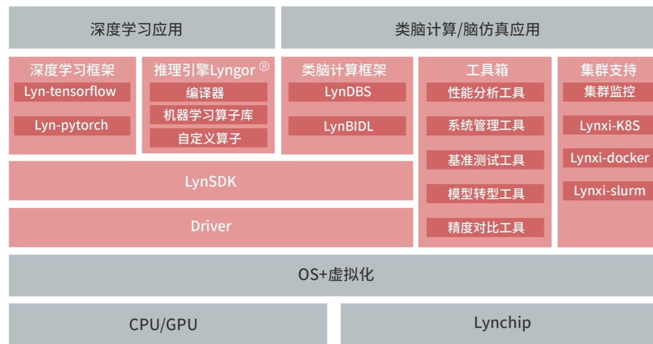
■ **LynSMI:** LynSMI (system management interface) 是硬件平台的系统管理工具，提供监控设备的使用情况和更改配置状态的功能，该工具是驱动附带的，只要安装好驱动后就可以通过命令行进行使用。
